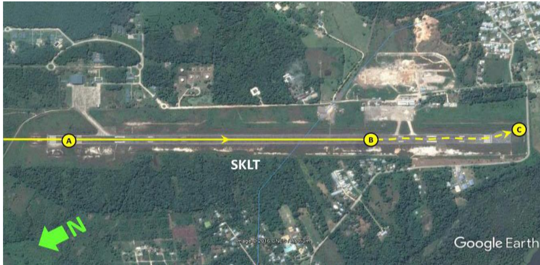
Fotografía No. 3: Recorrido general de la aeronave en la pista. "A" corresponde a la sentada de ruedas; "B" en donde se aplicaron nuevamente reversos. "C", corresponde a la posición final de la aeronave.
