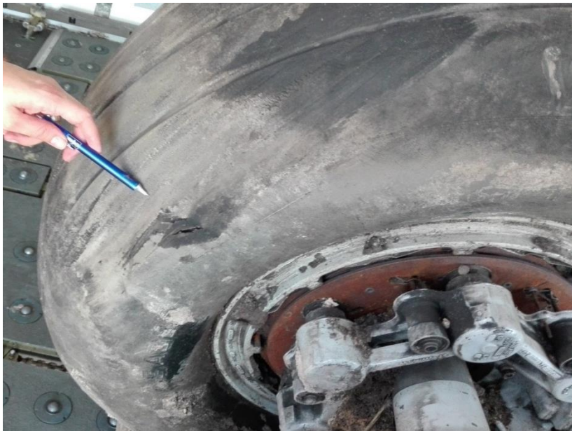
Fotografía No. 6: Evidencia del derrape llanta No.3
