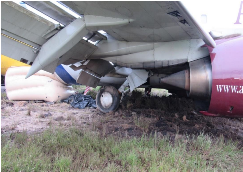
Fotografía No. 2: Imagen del daño en el tren principal derecho
